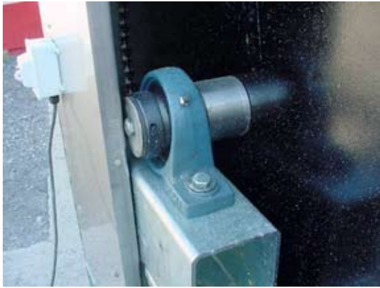
Photo 5 – Roulement de 2” dans le palier (pillow block)
